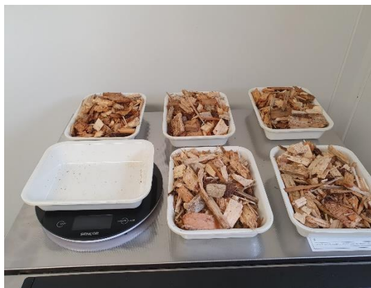
Foto: 1. Vzorkování paliva pro určení vlhkosti/sušiny v palivu; 2. Štěpkování v lokalitě Bílý potok
