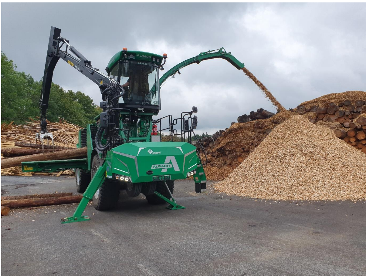
Obr. č.2: Úprava paliva štěpkováním
